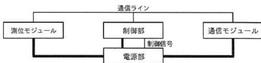
図 2 PRT のハードウェア構成
