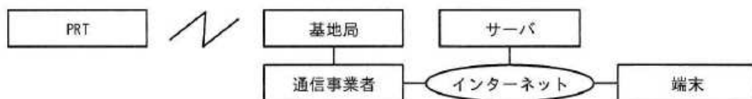
図1 PRTを用いた位置情報システムの構成
